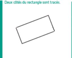
Pour tracer un rectangle, on utilise le gabarit d'angle droit pour les quatre angles droits et la règle graduée pour les côtés opposés (face à face) de même longueur.
